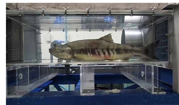
3-14 「スタミナトンネル」と呼ばれる実験用水槽に収容されたサケ
