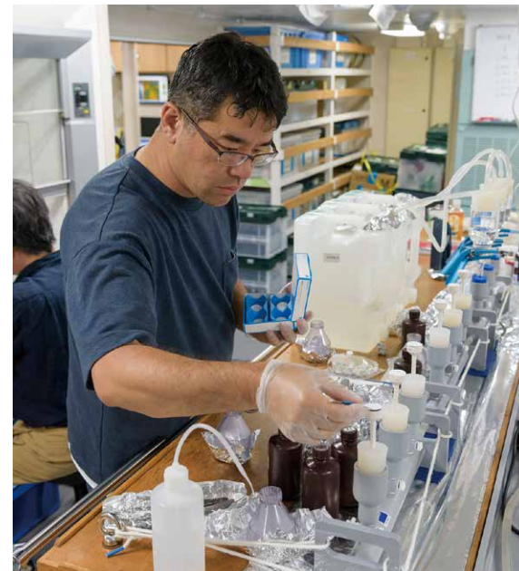
4-4 海水のろ過作業
