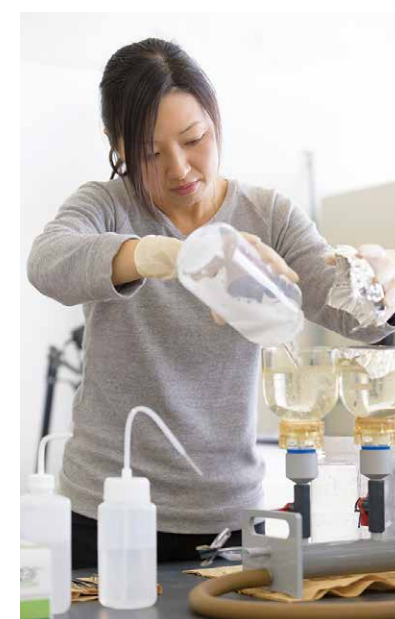
3-8 採水した水をろ過し、フィルターに残った組織片から DNA を抽出して分析する (撮影：山本祐之)
