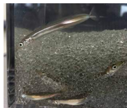
写真3：透明ビーズを入れた水槽を用いてイカナゴの潜砂実験
