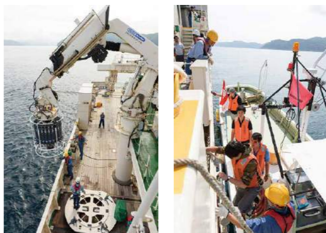
写真3：CTD観測と採水 温度、塩分、水温をリアルタイムで測定し表示するセンサーと、そのフレームに最大24本の採水器が装着されており、測定しながら採りたい深度で採水することができます。 写真2 漁師さんに備船をお願いし、メンバーの乗り換え。地元の方々のご協力なしに調査はできません。
