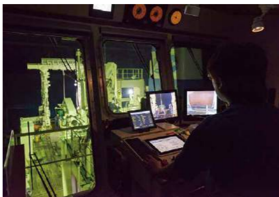
写真4：ウィンチ操作室 観測点までの距離や、船速、ワイヤーのテンションなどの情報と、甲板の状況を見ながら操作します。この日の作業は深夜に及びました。
