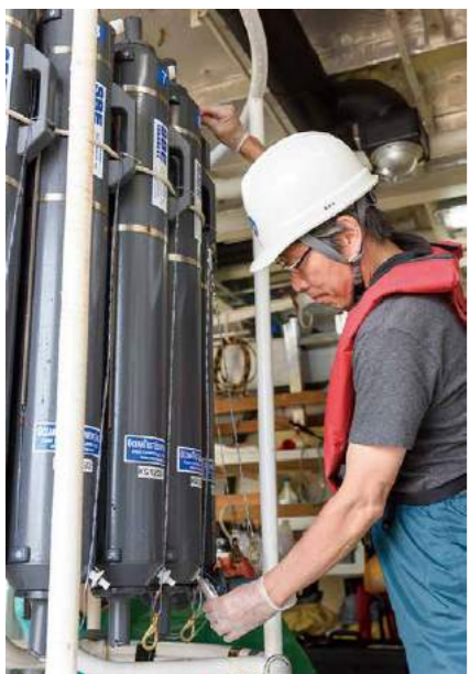
写真8 採水した海水は甲板上のCTD室で、目的別にポトルへ移します。
