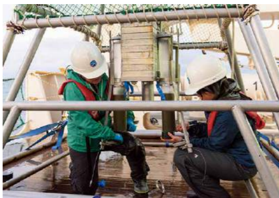
写真7 採泥したパイプの取り替え。泥の詰まったアクリルパイプは外され、空のパイプを取り付けます。
