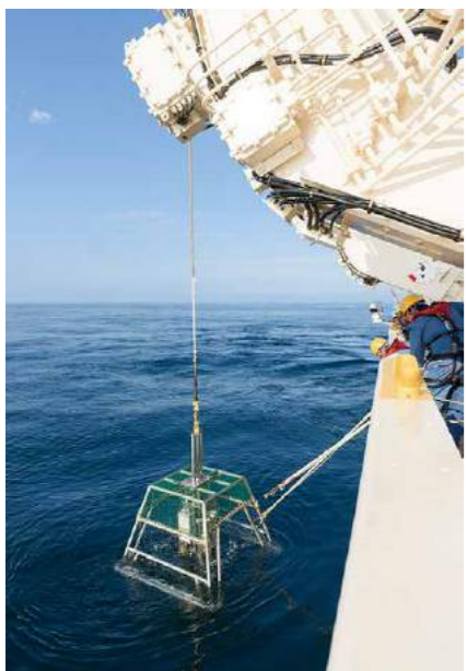
写真6：採泥器(マルチプルコアラ)の引き揚げ 今回の観測では、大槌・釜石沖の海底谷付近が陸起源物質のたまり場になっているのかどうか、それがどのようにたまっているかを調べました。
