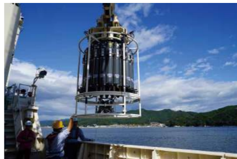
大型CTD採水システムによる観測 海水の塩分、水温、深度などを連続的に測定しながら、目的の深度で海水を採取する
