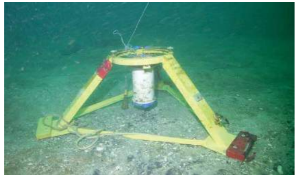
観測で使った係留系 海の決まった場所に測器を設置し、長期に渡り連続したデータを取得する係留観測によって、水の流れ、水温、塩分を記録した。
