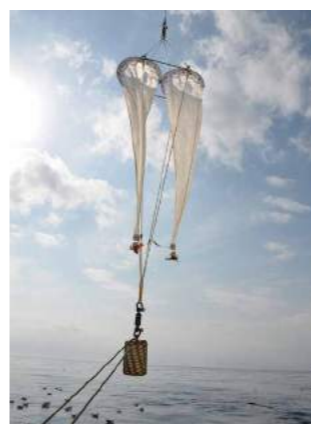
NORPAC ネット(North Pacific Standard Net) 東北海洋生態系調査研究船・新青丸での動物プランクトン採集風景。一定の深さから目の細かい網を引き上げて、海中のプランクトンを採集する。
