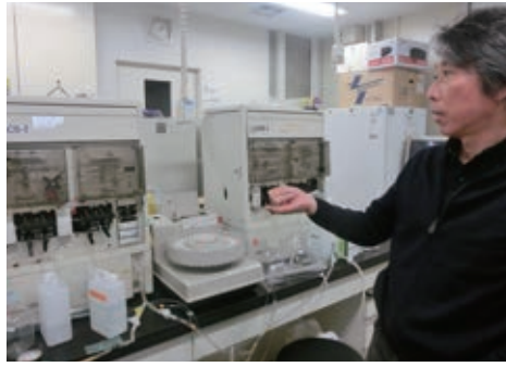
オートアナライザー。水質分析や食品分析など多方面で利用されている分析装置。液体の検体が流路内を通り、それぞれ分析したい項目ごとに試薬を入れて発色反応させるなどして、自動的に精密な解析を行うことができる
