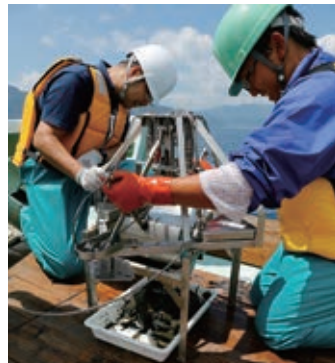
スミスマッキンタイヤ(グラブ採泥器)による採泥の様子
