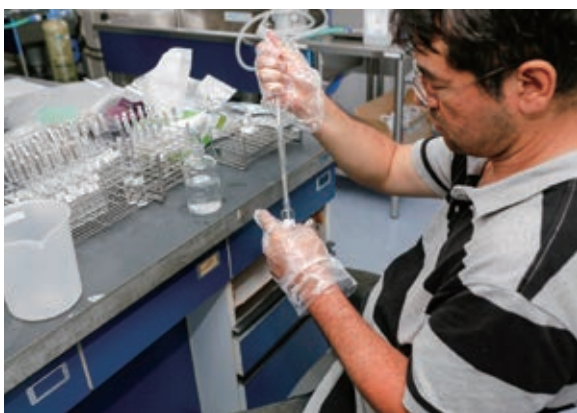
右: ニスキン採水器による採水。ワイヤーをつたって落ちてきたメッセージャーという重りがぶつかると、バネで上下の蓋が開まるしくみになっている 中央: プランクトンネットによるプランクトン採集 左: 分析する項目ごとに専用の容器に分取する
