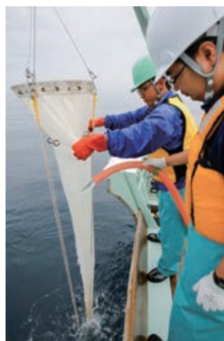
右: ニスキン採水器による採水。ワイヤーをつたって落ちてきたメッセージャーという重りがぶつかると、バネで上下の蓋が開まるしくみになっている 中央: プランクトンネットによるプランクトン採集 左: 分析する項目ごとに専用の容器に分取する
