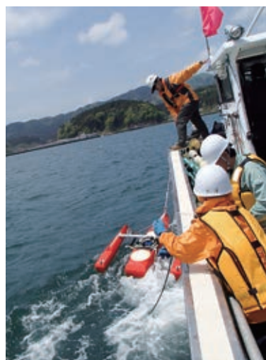
ADCP (acoustic Doppler current profiler) 海の中に超音波を放射して、海の塵や生き物にあたって戻ってくる反射波を解析し、海水の流速(向きと速さ)を計る
