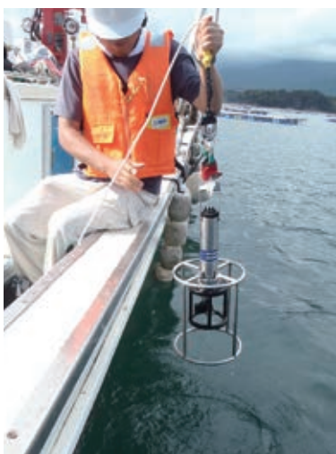
CTD (conductivity temperature depth) 深さ10cm刻みごとに、水温や塩分を計ることができる
