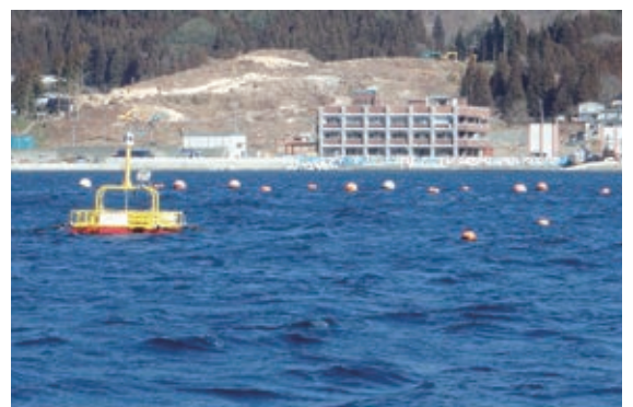
海象観測筏(水温プロファイル計・大槌湾) 大槌湾では様々な自動観測機器を用いて、海洋環境のモニタリングを実施。得られたデータはウェブ上でリアルタイム配信されている
